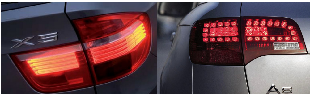
Abb. 12, Rückleuchten, Beispiel mit und ohne Lichtleiter
