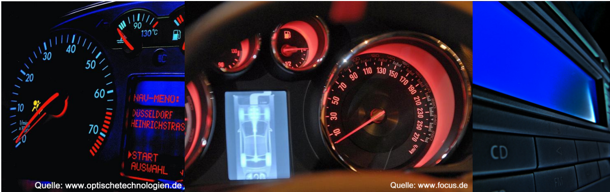
Abb. 2, Zeiger- und Symbolbeleuchtung, Displayhinterleuchtung
