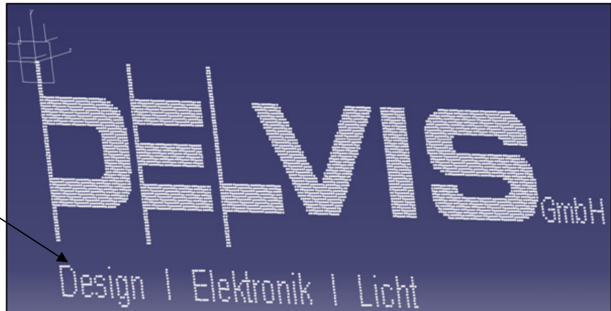
Abb. 13, Umsetzung der DELVIS Grafik in CAD-Geometrie (Kerben)
